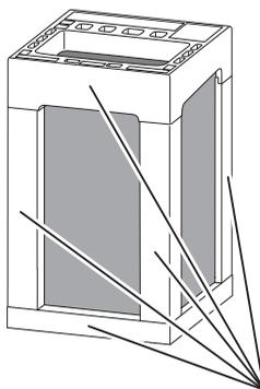
Remover todos os calços da embalagem antes de iniciar a utilização da lavadora. Nunca utilize a lavadora sobre o calço de EPS que acompanha o produto. Ele não suporta o peso da água e danifica os componentes inferiores da lavadora.
